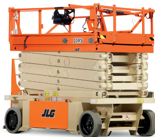
10RS in Transport Konfiguration mit abgeklappten Geländer
