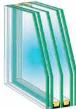
Vetro isolante e di sicurezza da mm. 34 (6/7 + 9 + 4 + 9 + 6/7) per pannello mm. 38-39
