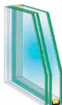
Vetro isolante e di sicurezza da mm. 19 (6/7 + 9 + 4) per pannello mm. 24
