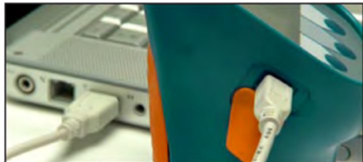
Port USB pour transmettre les mesures à un ordinateur.
