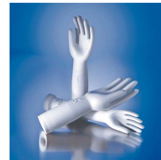
Handschuhtauchformen zur Herstellung von OP- und Behandlungshandschuhen
