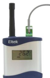
Eingänge für Temperatur- & Feuchte-Sonde DKRF300 oder RHT10E
