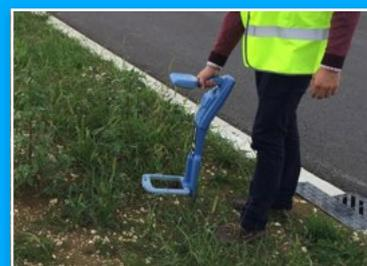
En associant la solution P340 avec une sonde et un détecteur électromagnétique conventionnel il est possible de localiser facilement avec grande précision la position et la profondeur de la caméra. Vous disposerez alors d'un outil précieux pour localiser l'emplacement d'un défaut, effectuer des réparations et bien pour tracer une canalisation; et ceci même dans un environnement électrique perturbé.
