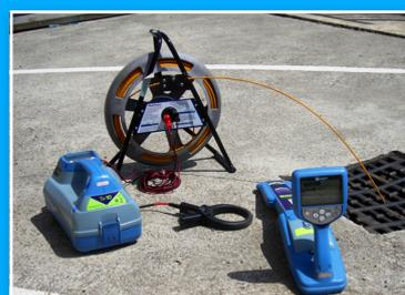
Pour utiliser le Gasena de manière optimale, il est nécessaire de connaître en amont la localisation de la canalisation sur laquelle on va travailler. Dans le cas contraire, l'opérateur pourra alors utiliser les méthodes complémentaires proposées par My-NDS en détection de réseaux enterrés, tels que le détecteur électromagnétique RD8100 et sa flexitrace, ou bien le géoradar QUANTUM tri-fréquences.
