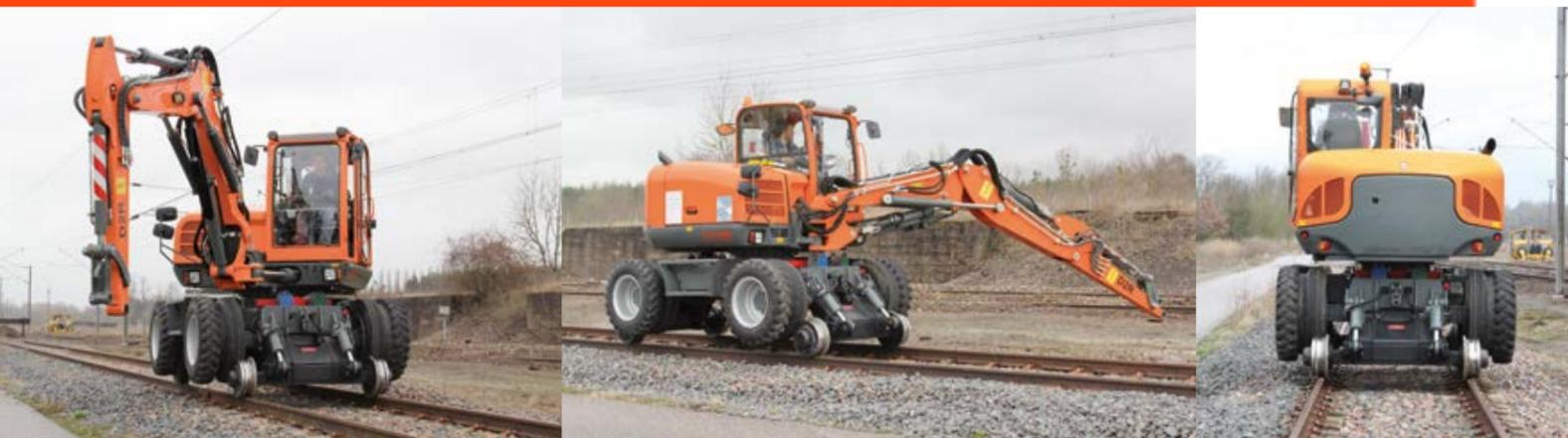
La fonction de compensation de débit (LUDV) de la pelle rail-route Z110PRR assure également une synchronisation optimale des mouvements du groupe de travail. Il est ainsi possible de combiner plusieurs mouvements simultanément, sans perte de puissance ni de vitesse. La progressivité et la précision sont parfaites dès la première impulsion de commande, indépendamment de la charge et du mouvement engagé.
