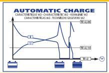
• Recarga las baterías de plomo al electrolito líquido a 100% (Curva W2) de 40 a 350Ah.
