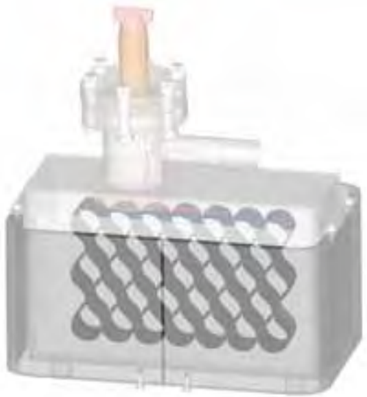
A 3D model of a Sem Ion Pump, specifically designed for Scanning Electron Microscopes. Un modello tridimensionale di una Pompa Ionica di tipo SEM sviluppata per la microscopia elettronica.
