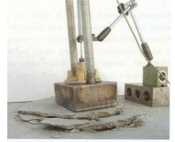
Abbildung 7, Zentrischer Zug (nach dem Versagen).
