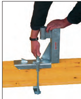
2. beweglichen Klemmbügel per Griff unter den Träger drehen
