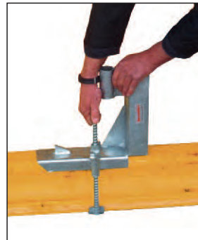
3. Griff nach oben ziehen und Flügelmutter fest ziehen;
