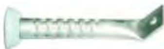
Alu-Ankerhülse DW-15 L= 130 mm kompl. mit PVC-Konus-Nagelstopfen amtliche Auszugprüfung für 40kN. Art.-Nr.: 15-608
