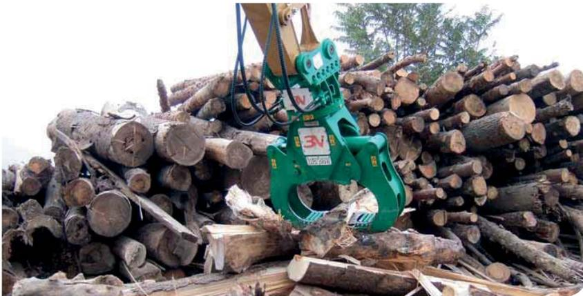
Die Serie **WS**, ein **Holzspalter** und **Sortiergreifer** in einem Gerät! Speziell für die Zerkleinerung und Sortierung von Holzstämmen. Eine Montage am Bagger oder Radlader ist möglich, damit ist dieses Anbaugerät vielseitig und flexibel anwendbar und in wenigen Minuten einsatzbereit. Mittels Vorspaltung erreicht man eine natürliche und schnellere Trocknung großer Holzstämmen. Der hydraulisch endlos drehende Drehkranz ermöglicht einen uneingeschränkten Bewegungsablauf.
