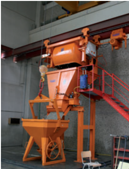
Kübat-Kübelbahn bei der Betonübergabe in der neuen Produktionshalle
