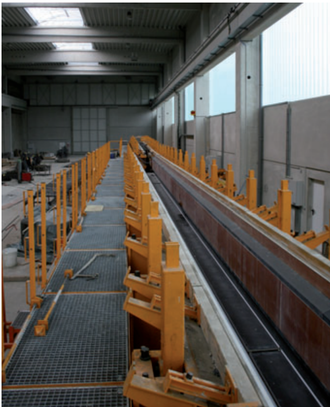
Die Binderschaling ist in vier Abschnitte zu jeweils 13,75 m aufgeteilt
