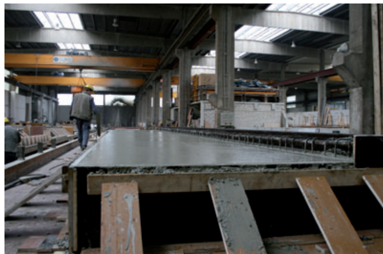
Auf den Tischen mit Stahl- oder beschichteten Holzoberflächen werden zum Beispiel Wände mit glatten Sichtbetonoberflächen gefertigt
