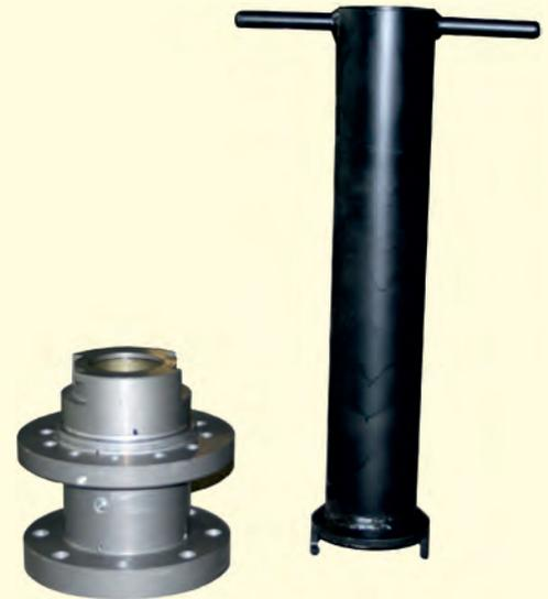
Neuentwicklung der Abdichtung der zentralen Ausgleichsstange. Sie wird durch Schmierfetteinpressung (A) gespannt, wenn gedichtet werden muss und entspannt durch Lösen der Flügelschraube (B), wenn keine Eingriff notwendig ist. (verschleißmindernd)
