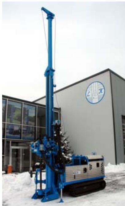
KB 20/100 in Betriebsstellung mit klappbarer Mastverlängerung
