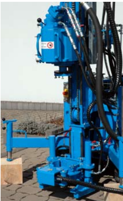
Bohrkopf, Hubspannschelle und mechanische Abstützungen
