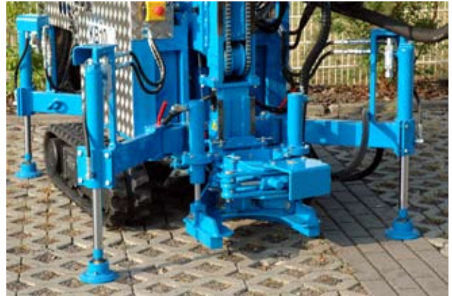
Hubspannschelle und hydraulische Abstützungen
