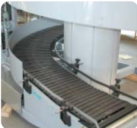
guidage chaîne sur roulements
