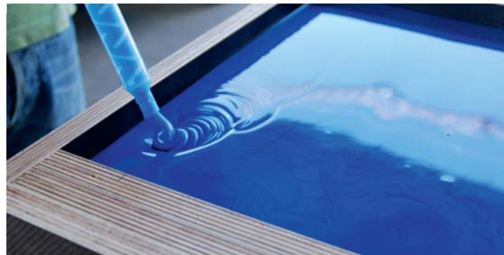
Das Bauunternehmen Schwarzkopf aus Schwäbisch Gmünd nutzt Mold Star® 30 Formen zur Serienreproduktion mit selbstverdichtendem Beton (Flowstone). Die SilCon III Mischmaschine erleichtert die Verarbeitung größerer Mengen Silikon und spart dem Unternehmen viel Zeit.
