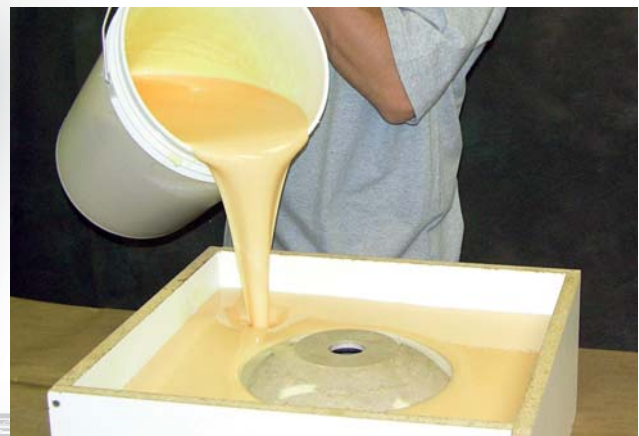
Zum Gießen einer 2-teiligen Negativform, für die Herstellung von Betonwaschbecken aus selbstverdichtendem Beton, wurde hier VytaFlex® 40 verwendet.
