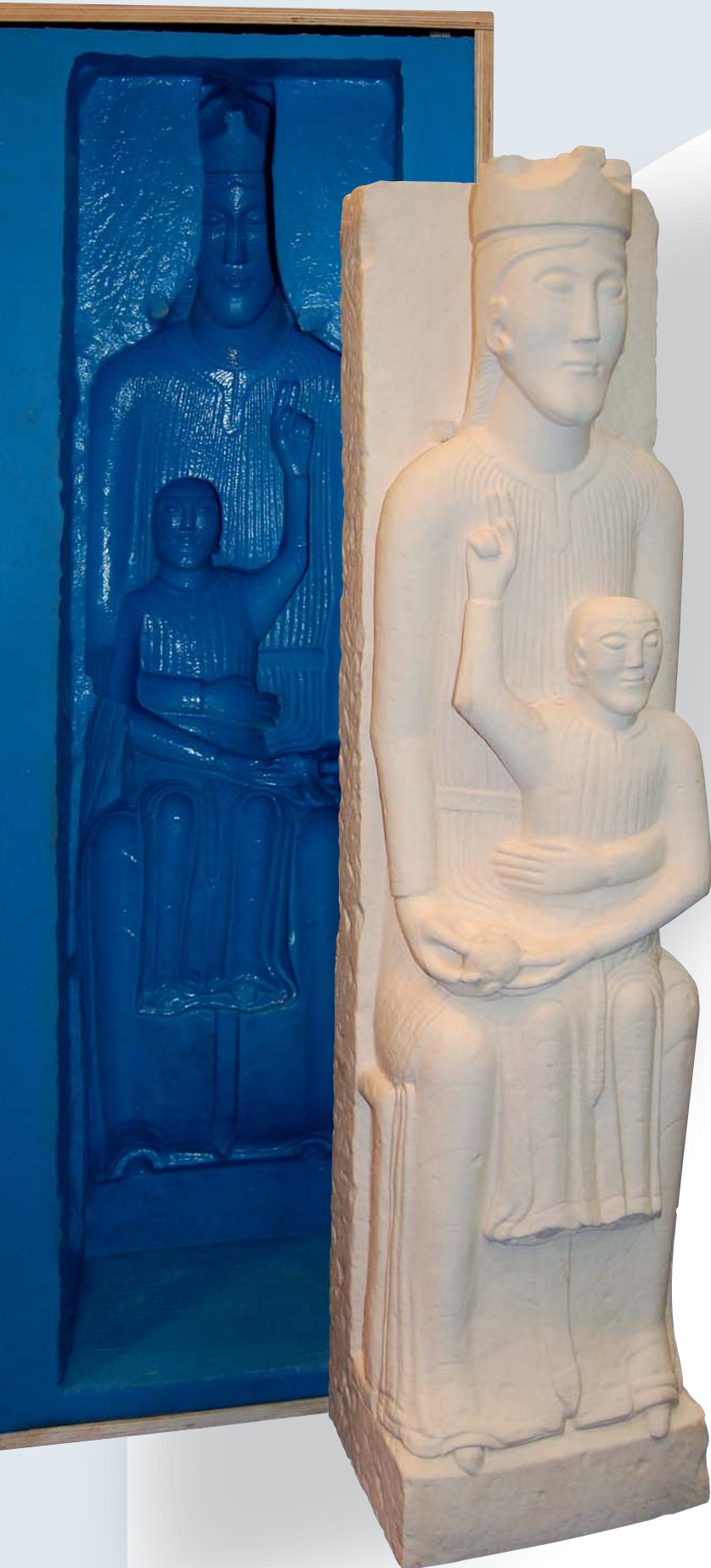
Das Bauunternehmen Schwarzkopf aus Schwäbisch Gmünd nutzt Mold Star® 30 Formen zur Serienreproduktion mit selbstverdichtendem Beton (Flowstone). Die SilCon III Mischmaschine erleichtert die Verarbeitung größerer Mengen Silikon und spart dem Unternehmen viel Zeit.
