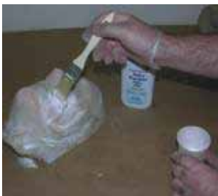
14. Um ein Aneinanderhaften der noch leicht klebrigen Oberfläche bei Falten zu vermeiden, streichen Sie ein wenig Talkum darüber.
