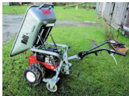
Ein stabiler Rahmen aus Rundrohren trägt die Kippmulde oberhalb des Motors. Die hinteren Lenkrollen sind mit einer Bremse ausgestattet.
