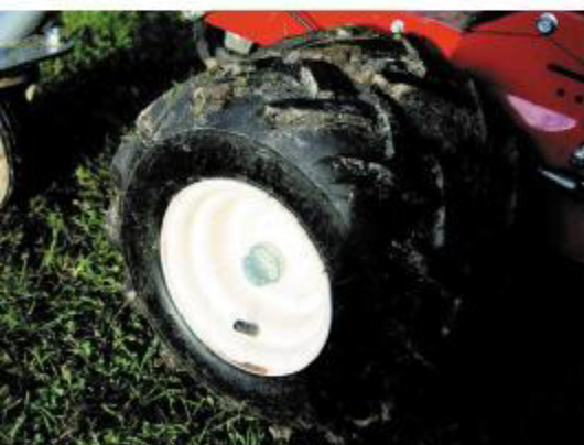
Optimal lässt sich der Multi-Dumper mit Doppelbereifung ausstatten, Reifengröße 13 x 5.00 - 6.
