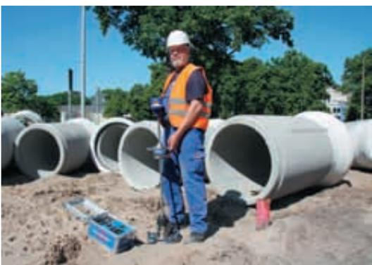
Sie erfüllen ohne großen Aufwand die Anforderungen an Verdichtungstests gemäß Güteschutz im Kanalbau, da das Gerät alle notwendigen Angaben für die obligatorische Eigenüberwachung automatisch aufzeichnet. Mit der PC-Software sind die Daten schnell ausgewertet und archiviert.
