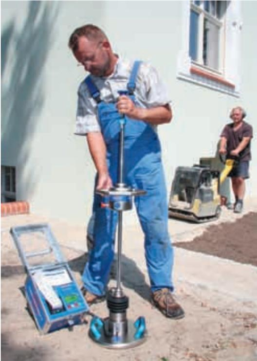
Machen Sie Ihre Verdichtungstests auf der Baustelle ab sofort selber! Der Verdichtungstest mit dem Leichten Fallgewichtsgerät TERRATEST 3000 <sup>GPS</sup> stellt wegen des geringen Prüfaufwandes und der einfachen Handhabung des Gerätes eine optimale Messmethode im Leitungsbau dar.
