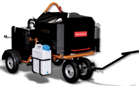
MAUS Typ 90B / 32-00 mit Abdeckhaube Bestell-Nr.: 32 00 00 00 (mit HONDA-Benzinmotor)
