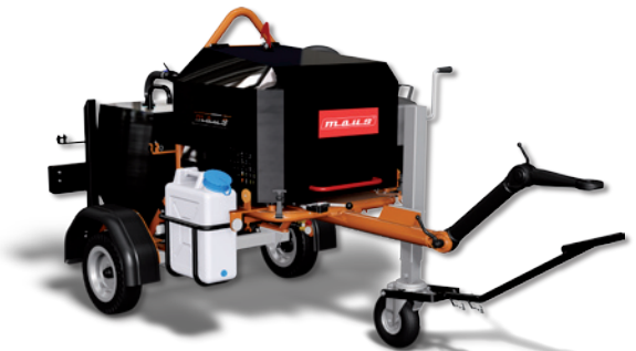
MAUS Typ 90B / 38-00 mit Abdeckhaube Bestell-Nr.: 38 00 00 00 (mit HATZ-Dieselmotor) Bestell-Nr.: 38 00 00 ES (mit HATZ-Dieselmotor, E-Start)
