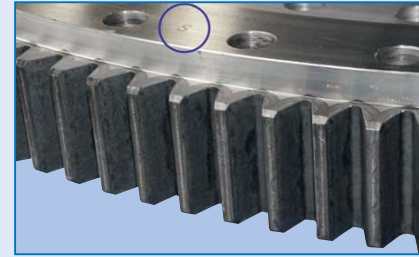
Kennzeichnung des Härteschlupfes Marking of soft-zone
