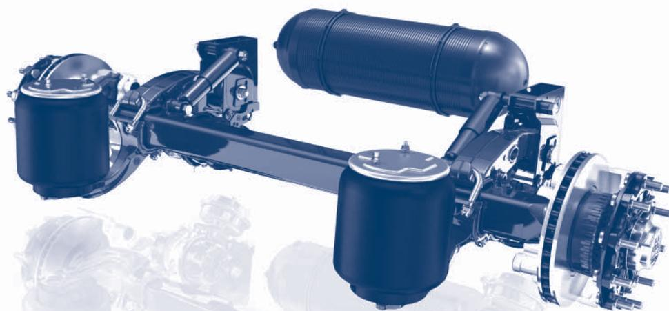
La suspension ECO Air COMPACT a été développée pour une utilisation standard sur les essieux 9t avec pneus en monte simple pour une utilisation sur route. Elle est disponible avec les variantes de freins à tambour SN 4218, ainsi que les freins à disque TSB 3709 et TSB 4309 en déport de 120.
