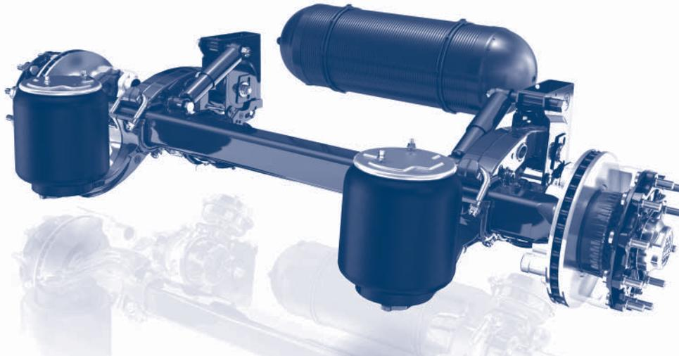
ECO Air COMPACT wurde für den Standardeinsatz 9t mit Singlebereifung im On-Road Einsatz entwickelt und ist mit den Bremsenvarianten Trommelbremse SN 4218 sowie den Scheibenbremsen TSB 3709 und TSB 4309 mit Einpresstiefe 120 erhältlich.
