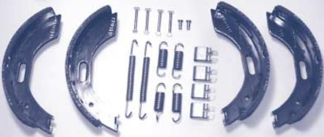
BPW Bremsbacken der Radbremse Typ-7
