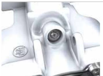
Dank des ECO Prinzips ist ein schneller Bremsscheibenwechsel ohne Demontage des Bremssattels möglich.
