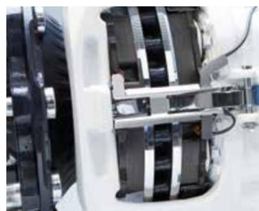
Verschleißsensor (optional): zuverlässige Technik, die rechtzeitig erkennt, wann die Verschleißgrenze der Bremsbeläge erreicht ist.
