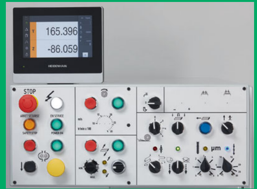
▲ Digitalanzeige für zwei Linearachsen zur Kontrolle der Längsbewegung
