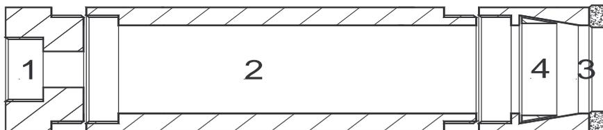
Kennzeichen dieses Systems ist die Möglichkeit über einen Kernfangring den Bohrkern abzureißen und zu fangen. Dieses System wird daher vorwiegend bei vertikalen und stark geneigten Bohrungen und auch bei Bohrungen die blind enden (Sacklöchern) verwendet.
