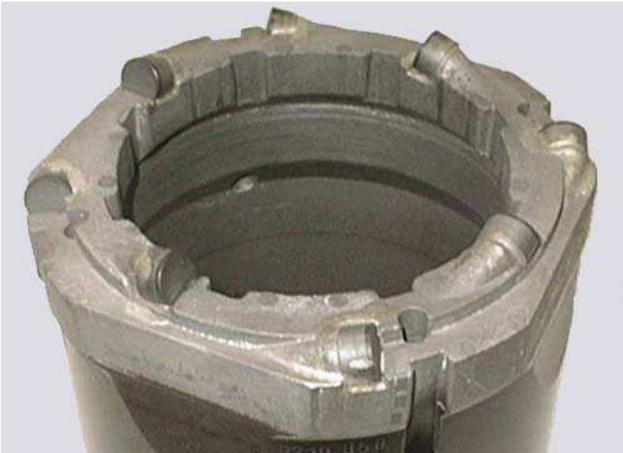
**Stratacut-Bohrkrone Stufenform mit Spülungsbohrungen und breiten Junkslots**
