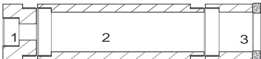
Dieses System findet vorwiegend Anwendung bei mehr oder weniger horizontalen Bohrungen oder Bohrungen über Kopf, wo ein Fangen des Kernes nicht erforderlich ist.
