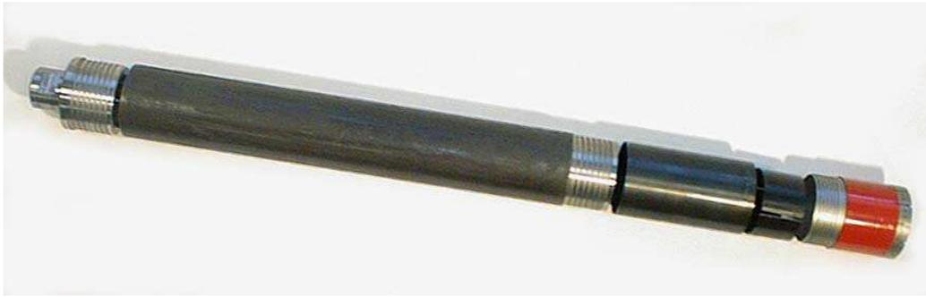
**Schraubbohrsysteme** sind Werkzeuge zum Kernbohren. Es handelt sich um Bohrkronen, die mit Rohren verlängert werden können. Der Antrieb erfolgt über ein aufgeschraubtes Kopfstück, das gleichzeitig den Übergang zum Anschlussgewinde des Bohrerätes darstellt.
