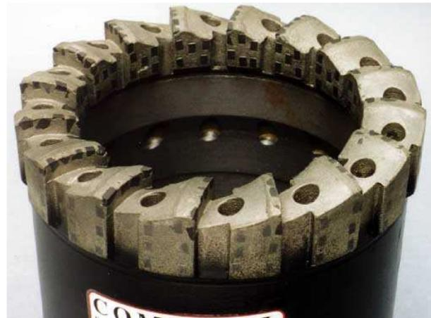
Synset-Diamantbohrkrone Sägezahnform mit Spülungsbohrungen
