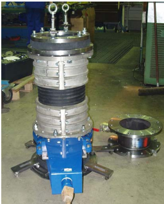
Preventer NW 250 mm mit Flachschieber und flexiblem Zwischenstück
