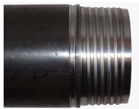
Konisches Trapezzgewinde mit Versleißanzeigenut Seilkernrohrgestänge 139,7 x 7,1 mm wd
