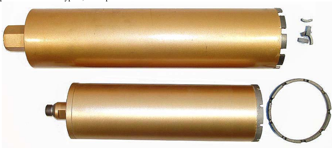
von oben: IBK Typ 50 (segmentiert, daneben einzelne Segmente) Typ 20 (ringgesintert, daneben Besatzring)
