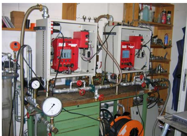
Druck-/Mengenmessgeräte Injektlim/Lugeonlim 4G im Dauertest
