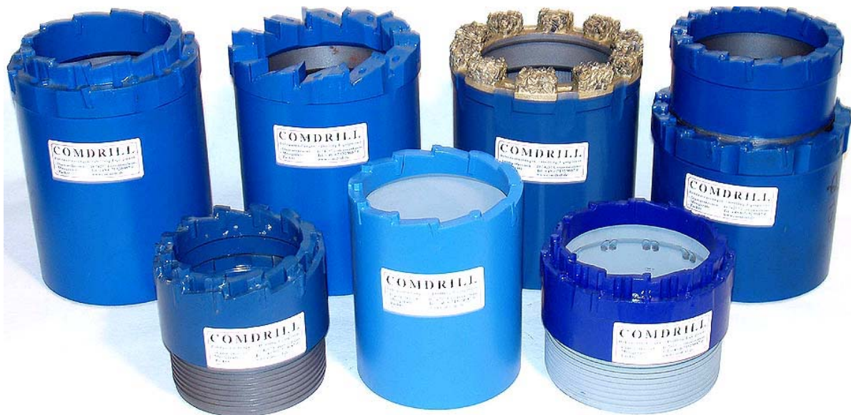
vordere Reihe v. links: Stufenkrone mit großen Spülungsbohrungen durch die Lippe, Standardkrone, Stufenkrone mit kleinen Spülungsbohrungen durch die Lippe hintere Reihe v. links: Pilotbohrkrone 15 mm, HM-Platten Bohrkronen (Meth. I), Corborit-Bohrkrone, Pilotbohrkrone zweiteilig mit 60 mm Pilot (Methode II)
