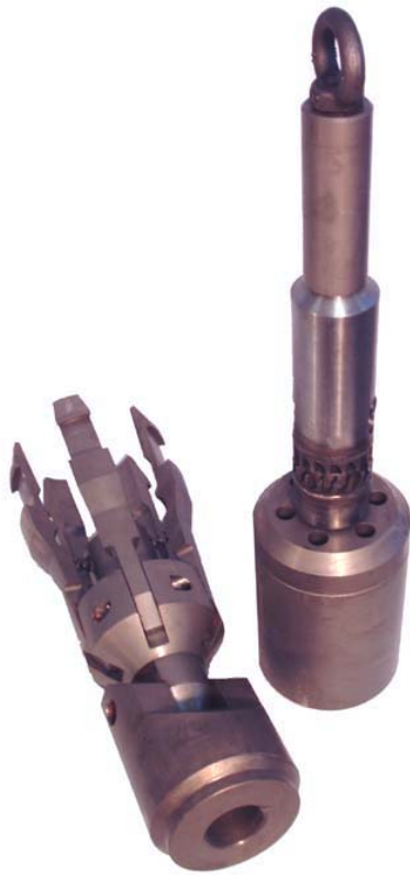
CSK 146 Kernrohrkopf (Teil), Overshot
