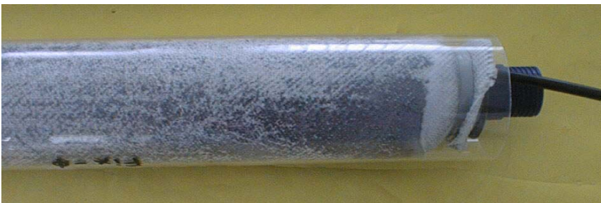
Filtergewebeschlauch NW 100 auf PVC-Rohr mit seitlicher Injektionsleitung Abdichtung mit Moosgummi
