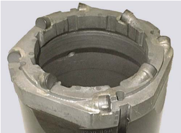
Stratacut-Bohrkrone Stufenform mit Spülungsbohrungen und breiten Junkslots
