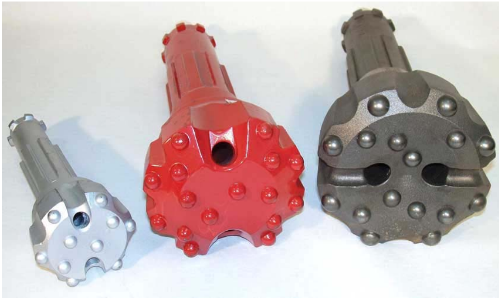
Stiftbohrkronen von links: flache Form, konkav, konvex
