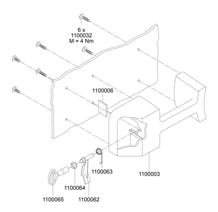
1100003 Hebegriff für Schlosseinbau 1100006 Verschlussplatte 1100032 Schraube 7x20 1100062 Schlossriegel 1100063 Schlossfeder 1100064 Bundbuchse 1100065 Dreikantschlüssel
