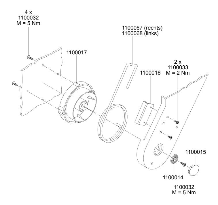
1100014 Scheibe 1100015 Abdeckkappe 1100016 Haltewinkel 1100017 Deckellager 1100032 Schraube 7x20 1100033 Schraube 6x16 1100067 Schenkelfeder links 1100068 Schenkelfeder rechts
