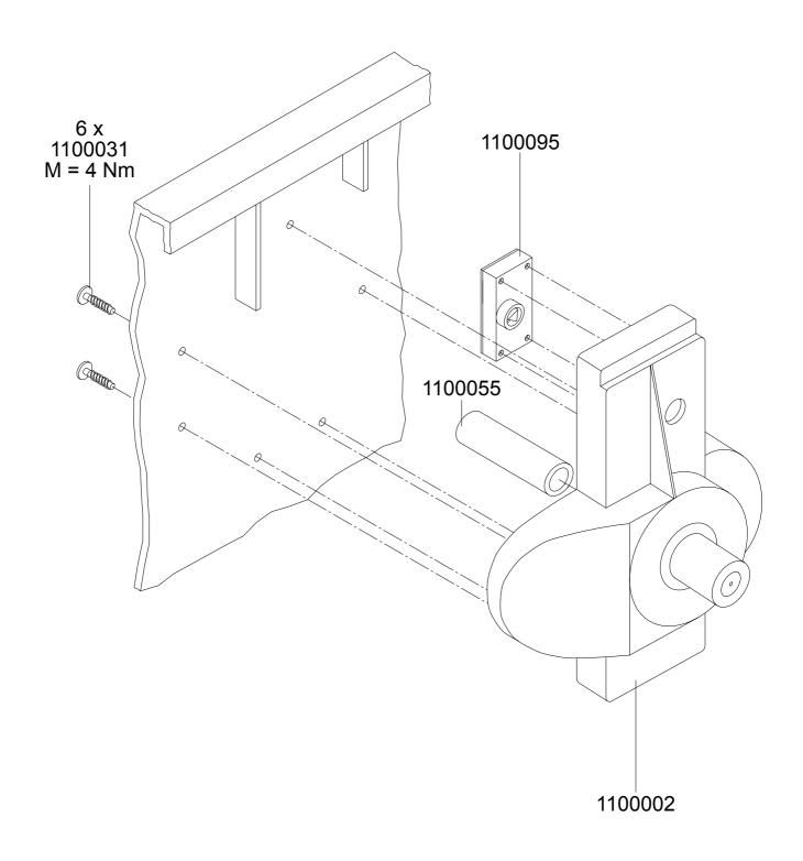
1100002 Aufnahmezapfen rechts 1100055 Aufnahmezapfeneinlage 1100095 Dreikantschloss Auf-/ Zu-Stellung 1100031 Schraube 7x30
