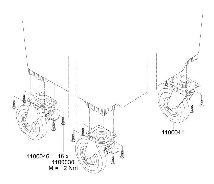
1100030 Schraube 10x40 1100041 Lenkrolle Kunststoff 1100046 Lenkrolle Kunststoff mit Radstop
