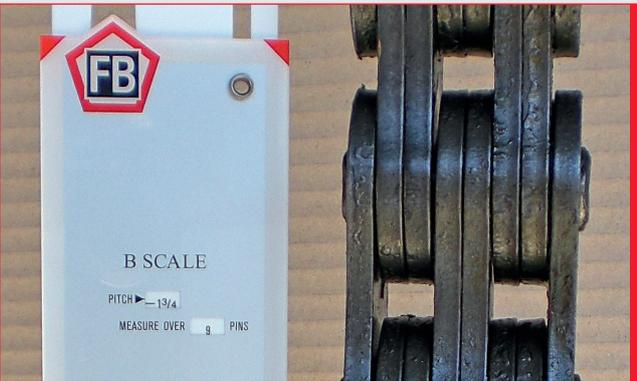
Die FB Kettenverschleißmesslehre hat in der Industrie Maßstäbe gesetzt und ist mittlerweile zu einem Standard-Werkzeug zur Ermittlung der Kettenlänge geworden. Diese patentierte professionelle Verschleißmesslehre ist einfach zu handhaben und liefert zu jeder Zeit und an jedem Ort genaue Messergebnisse.
