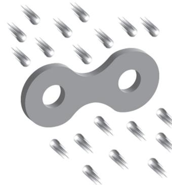
Nach erfolgter Wärmebehandlung werden alle Komponenten kugelgestrahlt, wobei Verunreinigungen entfernt und die Oberflächenbeschaffenheit optimiert wird.
