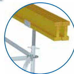
11) Vérin à tête „U“ • largeur d'ouverture : 160 mm • longueur d'appui : 150 mm • orifices pour la fixation de poutrelles de coffrage • levée max.: 0,45 m
