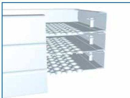
Très bonne gerbabilité (supersposable) de différents planchers acier
