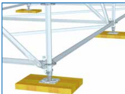
Exemple d'application de l'élément vertical de départ pour l'accrochage des tubes; Ecart entre le bord inférieur du tube et la premier disque à trous: 6,5 cm
