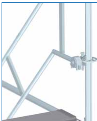
Exemple d'application pour fixation du garde-corps d'escalier à l'aide d'un collier en plat à boudes au support de garde-corps
