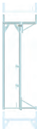
Exemple d'application Console 0,36 m et Embase console basse avec cadre 0,37 m en tant que porte-à-faux
