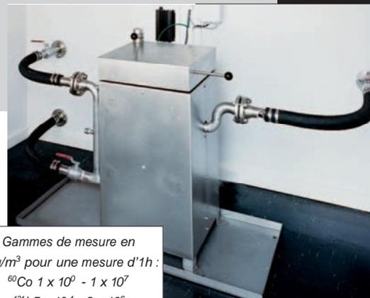
Gammes de mesure en kBq/m<sup>3</sup> pour une mesure d'1h :
