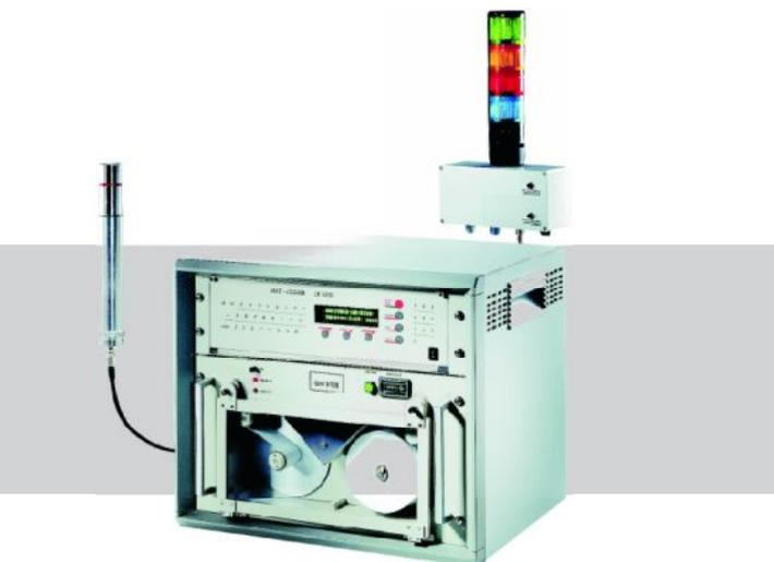
Pour un débit d'air de 3,3 m<sup>3</sup>/h, la limite de détection pour 1 heure de temps de mesure est de 6 mBq/m<sup>3</sup> en alpha et 40 mBq/m<sup>3</sup> en bêta.
