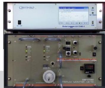
Pour des mesures spécifiques et de haute sensibilité du tritium dans l'air, **BERTHOLD TECHNOLOGIES** a créé le moniteur **LB 110** avec compteur proportionnel à circulation de gaz et spectrométrie bêta.
