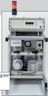
Avec son seuil de détection de 0,5 kBq/m<sup>3</sup>, le LB 110 est environ 100 fois plus sensible que les instruments à chambre d'ionisation conventionnels. La plage de mesure s'étend jusqu'à 20 MBq/m<sup>3</sup>.
