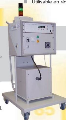
Un moniteur adapté : **le moniteur mobile pour air BAI 9850-19/PINN** mesure simultanément les aérosols (P), l'iode 131 (I) et les gaz rares (N) avec une large dynamique.
