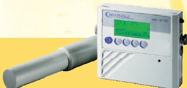
*Le polyradiamètre LB 123 Umo équipé d'une sonde gamma à scintillateur NaI pour la détection de sources ou de déchets radioactifs.*
