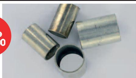
Tubes à écraser dans un étau ou à la presse, puis à contrepercer au diamètre
