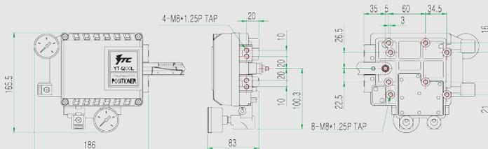
Le positionneur pneumatique YT-1200L permet la régulation en continue via un signal pneumatique des vannes de process équipées de servomoteurs pneumatiques linéaires.
