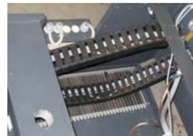
Platzsparender Einbau einer E2/000 e-kette® in einem Spritzwerkzeug Space-saving: E2/000 e-chain® in an injection molding tool
