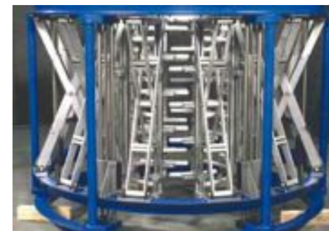
Schmierfreie iglidur®-Gleitlager in einem Kalibrierkorb in einer Blasfolienanlage Lubrication-free iglidur® bearings in a calibration cage in a blown film line
