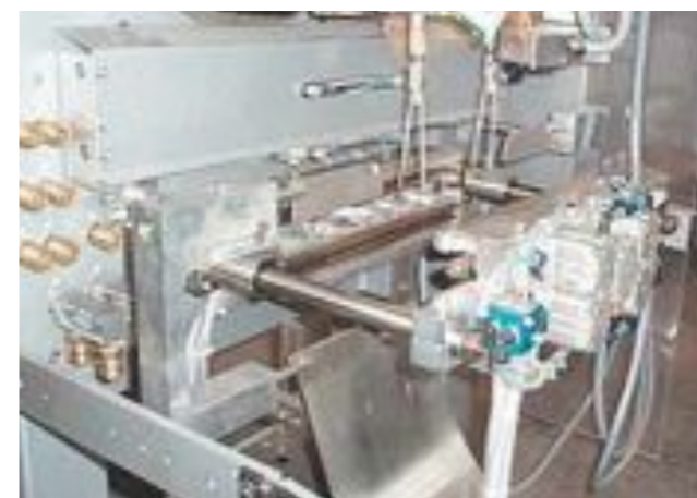
iglidur® Z bei hohen Temperaturen in dieser Schlauchbeutelmaschine iglidur® Z at high temperatures in this bag forming, filling and sealing machine
