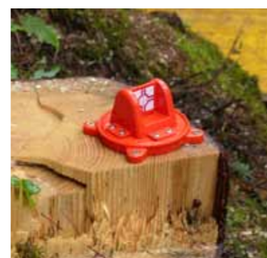
Exemples d'application RS193rM comme point fixe sur différentes surfaces et pour l'alignement exact du chariot de forage.
