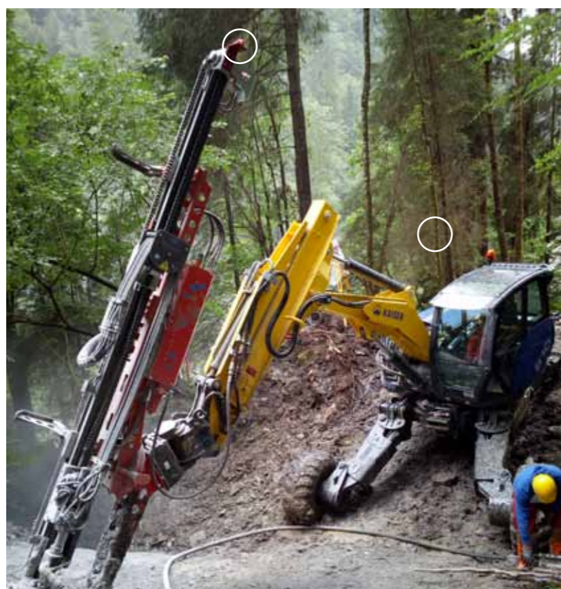
Exemples d'application RS193rM comme point fixe sur différentes surfaces et pour l'alignement exact du chariot de forage.
