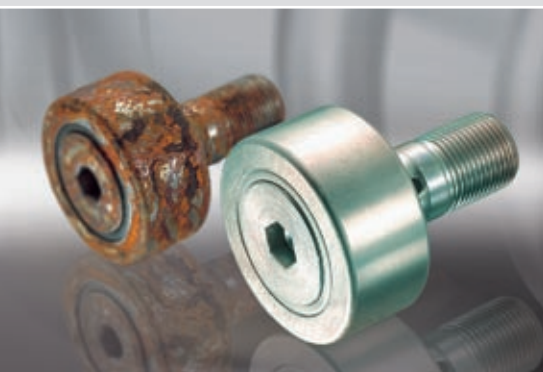
Galet sans revêtement et galet avec revêtement Corrotect® après un essai d'exposition au brouillard salin
