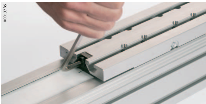
Figure 27 Fixation par vis du tendeur sur le chariot mobile
