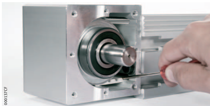
Figure 25 Mise en place de la courroie crantée sur la poulie d'entraînement
