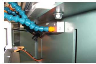
Le dispositif de soufflerie du tampon peut être fixé par magnétisme.
