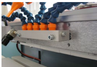
Le dispositif de soufflerie du tampon peut être monté avec des vis latéralement.
