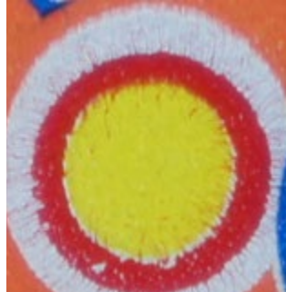
Exemple d'une impression médiocre due à une décharge électrostatique
