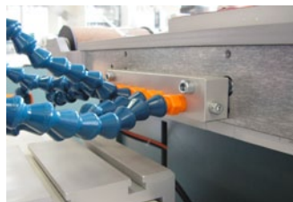
Le dispositif de soufflerie du tampon peut être monté avec des vis horizontalement.
