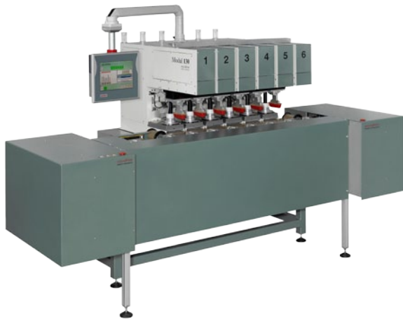
6 Système polychrome pour l'impression autour de stylos à bille
