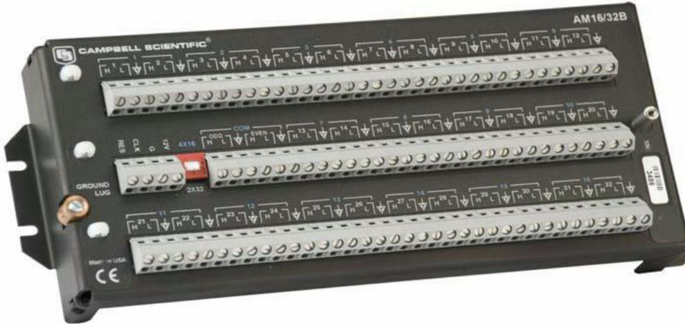
Le multiplexeur à relais AM16/32B augmente le nombre de capteurs qui peuvent être mesurés par une centrale de mesure. Il multiplexe 16 groupes de 4 voies (un total de 64 voies) à travers quatre terminaux communs (COM). A l'aide d'un commutateur (switch) manuel vous pouvez configurer l'AM16/32B pour multiplexer 32 groupes de 2 voies (soit un total de 64 voies) à travers seulement 2 terminaux COM.
