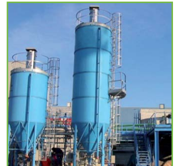
» FILTRES ÈVENT SILOS
