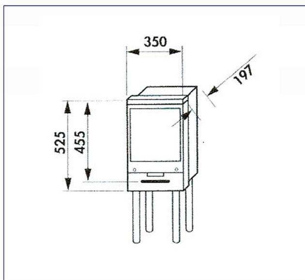
Matériau : ciment renforcé en fibre de verre (CCV) - Façade beige - Poids : 49 Kg
