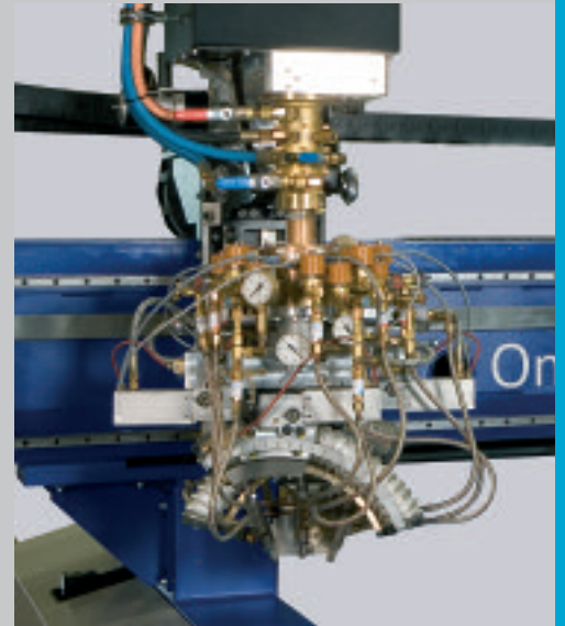
Tête automatique DAFL, chanfrein évolutif et rotation illimitée pour Oxycoupage multi-chalumeaux V, Y ou K
