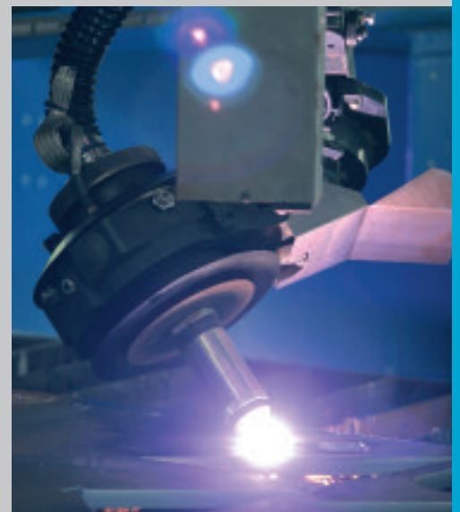
Tête Plasma chanfrein type Skew Axis Rotator Δ permettant des coupes chanfrein automatiques
