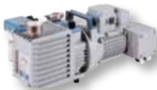
O parceiro perfeito para o seu liofilizador. A RC 6 é uma combinação de uma bomba rotativa de palhetas de dois estágios e de uma bomba de diafragma com resistência química, que reduz o acúmulo de resíduos. Oferece excelente vazão, necessidades de manutenção muito reduzidas e muito menos acúmulos de resíduos de óleo.
