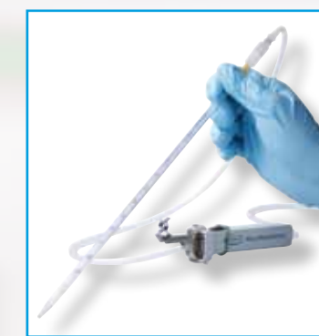
Достижение точных результатов при использовании градуированной пипетки
